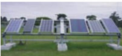
Vergleichsanlage für PV-Module an der Universität Murdoch, Australien. Photovoltaik ist weltweit ein aktuelles Thema.
